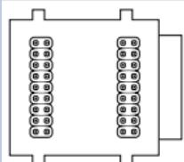
Bus-Verbinder: dieser ist in der Rille der DIN-Schiene zu lagern, um die eventuellen I/O-Module an den PL500 anzuschliessen. Zur Montage siehe Abschnitt 2.2.
