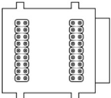
Connettore bus da alloggiare nell'incavo della barra DIN per connettere gli eventuali moduli I/O al PLC. Per la sequenza di montaggio, vedere paragrafo 2.2.
