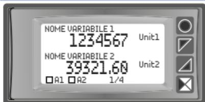
Visualizza il valore delle prime due variabili abilitate con relative descrizioni ed unità di misura e lo stato dei relè di allarme. La figura rappresenta la visualizzazione relativa all'impostazione "2 val. per pag." nel parametro "Display -> Visualizzazione"
