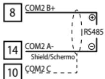
Per la connessione ad un dispositivo Modbus master
