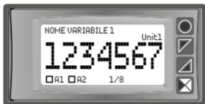
Visualizza il valore della prima variabile abilitata con relativa descrizione ed unità di misura e lo stato dei relè di allarme. La figura rappresenta la visualizzazione relativa all'impostazione "1 val. per pag." nel parametro "Display -> Visualizzazione". La scritta 1/8 in basso, indica che si sta visualizzando la prima di 8 pagine utilizzate per la rappresentazione delle variabili abilitate.
