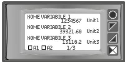
Visualizza il valore delle prime tre variabili abilitate con relative descrizioni ed unità di misura e lo stato dei relè di allarme. La figura rappresenta la visualizzazione relativa all'impostazione "3 val. per pag." nel parametro "Display -> Visualizzazione"
