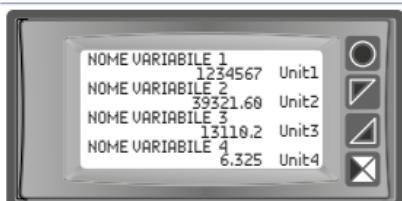
Visualizza il valore delle prime quattro variabili abilitate con relative descrizioni ed unità di misura e lo stato dei relè di allarme. La figura rappresenta la visualizzazione relativa all'impostazione "4 val. per pag." nel parametro "Display -> Visualizzazione"
