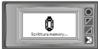
Per salvare una configurazione dei parametri nella memory card, a strumento acceso, collegare la stessa al connettore micro-USB, entrare in configurazione, impostare i parametri come necessario, e uscire dalla configurazione. A questo punto, lo strumento riconosce la presenza della memory card e salva la configurazione appena realizzata anche sulla memory.
