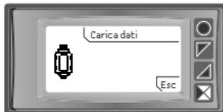
Per caricare una configurazione precedentemente realizzata e salvata su una memory card, collegare la stessa al connettore micro-USB ed alimentare lo strumento. A questo punto, se la memory viene rilevata e i dati in essa contenuti sono considerati validi, sul display verrà visualizzata la richiesta di caricamento dei dati da memory. L'utente ha due possibilità, Carica dati caricare i parametri dalla memory o Esc per annullare l'operazione senza modificare la configurazione attuale.
