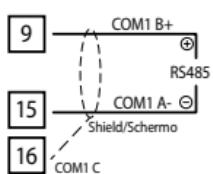
Per la connessione a dispositivi Modbus slave
