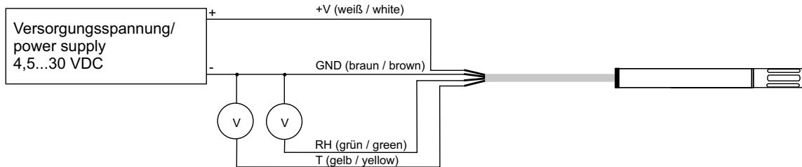
Bei Kabellänge > 500mm ist die Anbindung des Kabelschirms zur Gewährleistung der EMV Kompatibilität zwingend notwendig!
